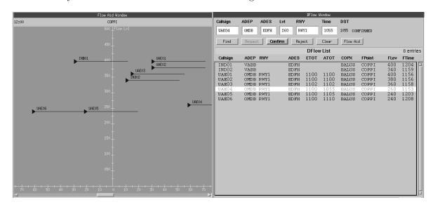
Abbildung 6.2: Links: das Flow Aid Window zeigt eine graphische Übersicht der Flow Point Slot-Verteilung über Zeit und Flugfläche. Rechts: das DFLOW Window stellt die Interaktion mit der DFLOW-Komponente dar samt Übersicht über die erfasste Flugpläne.
