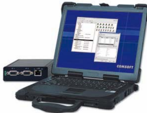
Abbildung 5.2: RAPS-3: System zum Testen, Verifizieren, Aufnehmen und Abspielen von ASTERIX-Datenströmen
